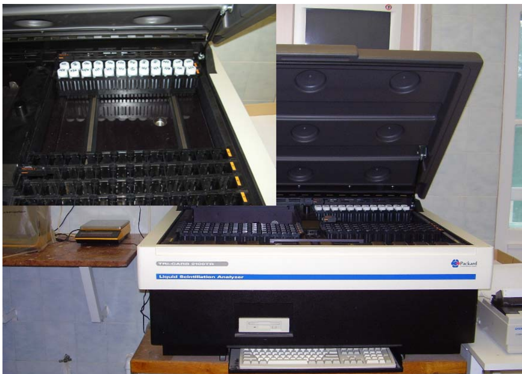
3. ábra: A folyadék-szcintillációs radioaktivitásmérő készülék
