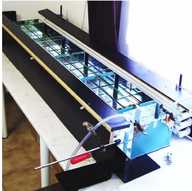
4. ábra: A fotoszintetron a fitoplankton minták inkubálására
