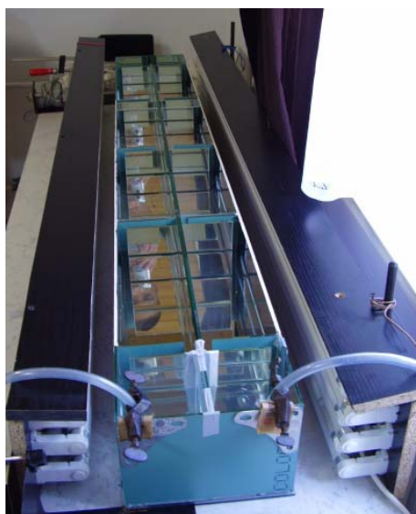
5. ábra: A fotoszintetron a fitoplankton minták inkubálására
