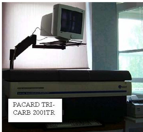
6. ábra: A folyadék-szcintillációs radioaktivitásmérő készülék
