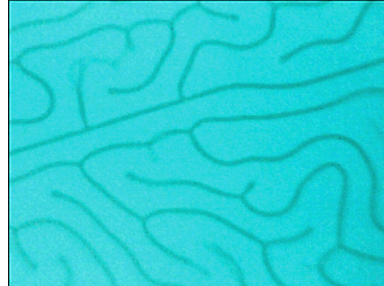
4. ábra-folytatás. A grafikonon a tekercsen átfolyó áramerősséget ábrázoltuk az idő függvényében, alatta pedig a ferrimágneses vékonyréteg doménszerkezete látható a megfelelő időpillanatban.
