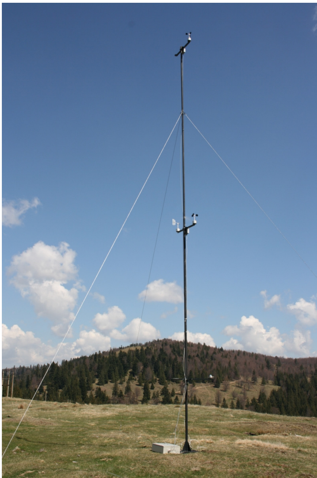
A Floroiu mérőponton felállított automata meteorológiai állomás, 5 méteren szélesség és széliránymérő, 10 méteren szélesség mérő
